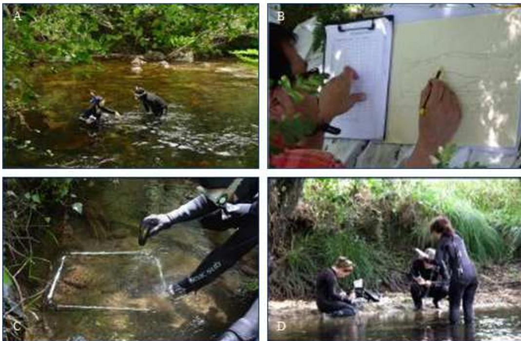
**Figura A.4.1.1.** A.- Muestreo Fase 1 con equipo de apnea. B y C.- Muestreo fase 2. Delimitación del tramo para el cálculo de la superficie de muestreo, y muestreo por estratos con cuadrados aleatorios. D. Toma de muestras para análisis físico-químico.
