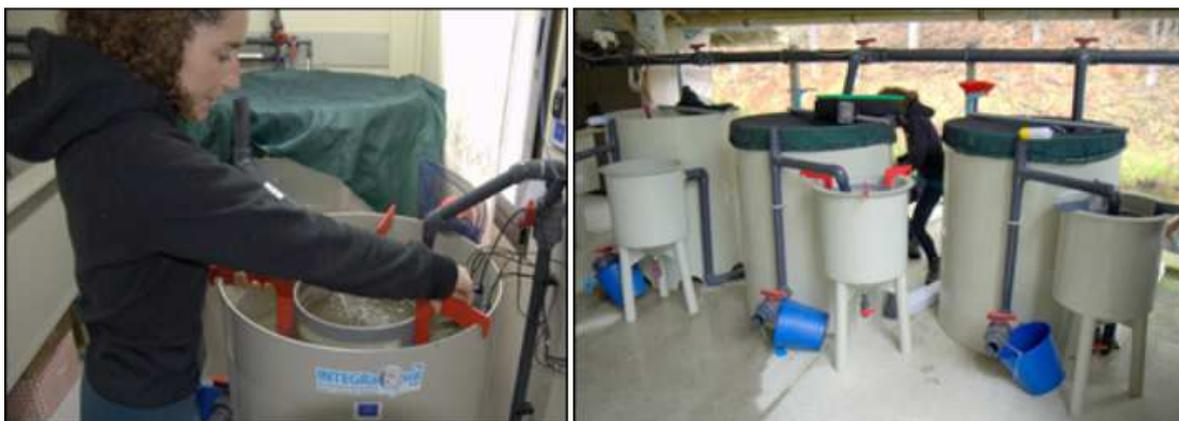
**Figura C.4.1.8.** Recogida de semillas en el tamiz (izquierda) y circuito exterior abierto de recogida (derecha).
